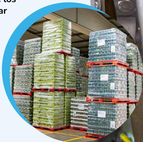
**Reducción del gramaje del plástico retráctil en las bandejas**, para lo que se han tenido que adaptar tanto la maquinaria retráctiladora como los hornos. Esta medida ha supuesto un ahorro de un **24%** del **material plástico** usado para este fin.
